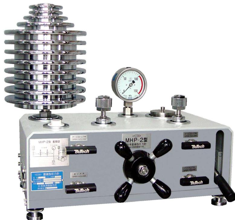
MHP-2型重錘型圧力標準器は中圧における圧力計及び各種圧力センサの校正用圧力標準器です。重錘を用いて油圧により軽い加圧操作で測定でき、予圧ポンプを内蔵していますので容量の多い測定器などの作業が短縮できます。また、加圧及びバルブ操作もスムーズにできる様に前面パネルに設置しました。安全性にも考慮して配管及び継手、主要部品にはステンレス材を使用しています。
