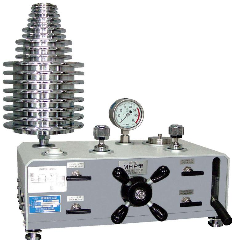
MHP型重錐型圧力標準器は中圧における圧力計及び各種圧力センサの校正用圧力標準器です。重錐を用いて油圧により軽い加圧操作で測定でき、予圧ポンプを内蔵していますので容量の多い測定器などの作業が短縮できます。また、加圧及びバルブ操作もスムーズにできる様に前面パネルに設置しました。安全性にも考慮して配管及び継手、主要部品にはステンレス材を使用しています。
