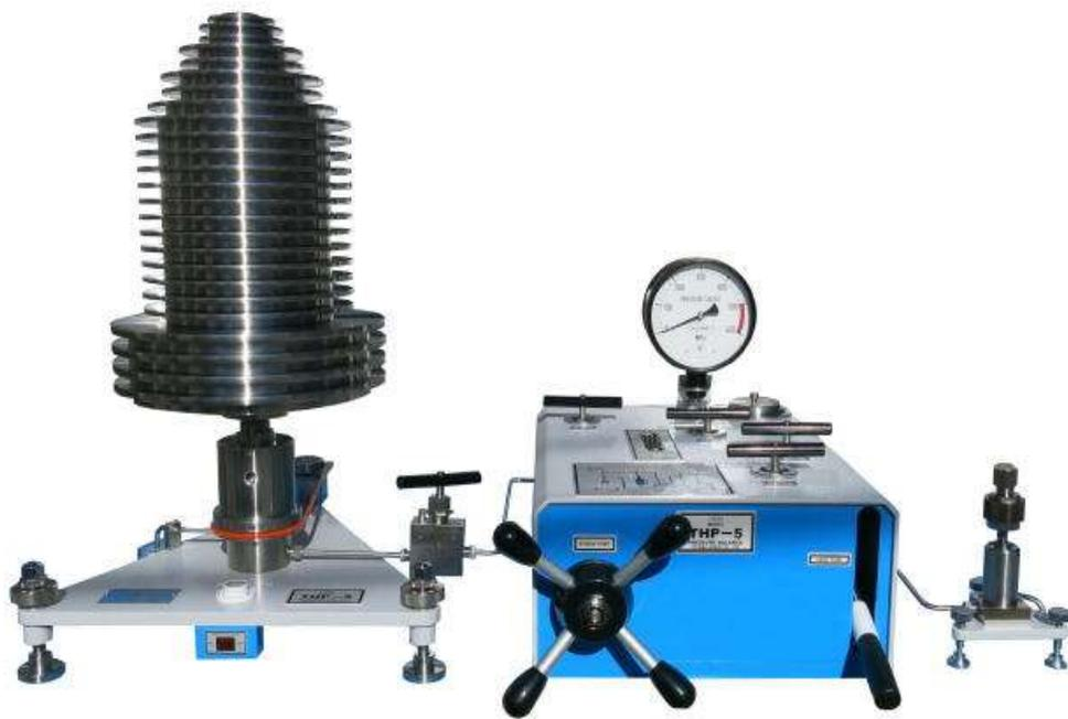
THP-5型重錘型圧力標準器は超高圧における圧力計及び各種圧力センサの校正用圧力標準器です。重錘を用いて油圧により軽い加圧操作で測定でき、予圧ポンプを内蔵していますので容量の多い測定器などの作業が短縮できます。また、加圧及びバルブ操作もスムーズにできる様に上面パネルに設置しました。安全性にも考慮して配管及び継手、主要部品にはステンレス材を使用しています。
