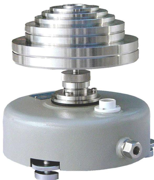
AP-01型空気式重錘型圧力標準器は従来の液柱型圧力計に変わり、重錘を使い気体を圧力媒体とした高精度の低圧用エアーストンゲージです。測定範囲は5 kPaより500 kPaまでの圧力を測定できます。精度は発生圧力の0.01 %以上を確保し、各圧力レンジにおける発生圧力は抜群に安定しており、気体圧力計及びデジタル圧力計等各種圧力センサの校正用標準器として最も信頼のおける製品です。尚、本器の使用に際しては手動加減圧ポンプ(V1型・V2型)等の気体圧力源が必要です。
