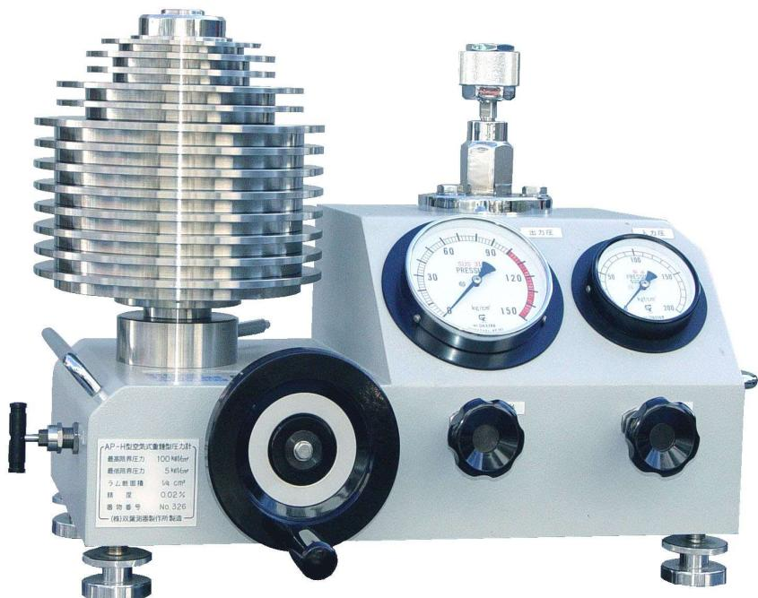
AP-H型空気式重錐型圧力標準器は重錐を使い気体を圧力媒体とした高精度の高圧用エアーピストンゲージです。最大測定圧力は、5 MPaと10 MPaの2種類があり、従来油圧で測定していた圧力範囲をカバーできます。精度は発生圧力の0.02 %以上を確保し各圧力レンジにおける発生圧力は抜群に安定しており、気体圧力計及びデジタル圧力計等各種圧力センサの校正用標準器として最も信頼のおける製品です。尚、本器の使用に際しては圧力コントロール部を内蔵していますが圧力源としてボンベ(空気又は窒素)等が必要です。また、kPa 単位でも製作が可能です。
