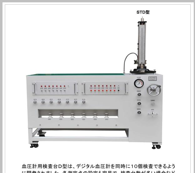
血圧計用検査台D型は、デジタル血圧計を同時に10個検査できるように開発されました。各測定点の設定も容易で、検査台数が多い場合など短時間で効率よく作業ができます。なお、検査に使用する液柱型圧力計は、当社製品のSTD型を推奨いたします。
