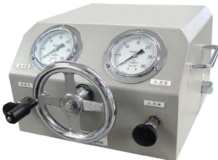
V5型圧力コントローラーは、AP-02型等の気体圧力での重錘型圧力標準器や被測定器に測定圧力(2 MPaまで)を供給できる圧力コントローラーです。窒素ボンベ又は高圧コンプレッサーにより発生した高圧気体を調圧弁を通して2.3MPa以下に調圧し接続します。入力弁により測定圧力の±0.2 MPa位まで導入し、手動ポンプにより微調整し重錘型圧力標準器や被測定器をコントロールします。
