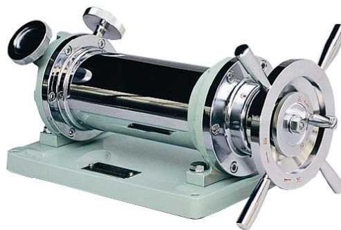
V1、V2型手動加減圧ポンプは、気体圧力重錘型圧力標準器、液柱型圧力計、デジタル圧力計、各種圧力センサ及び工業計器等の調整、検査用の空気源として気体圧力の加圧減圧に使用する手動加減圧ポンプです。外気(空気等)をポンプ内に吸入して加圧することにより最大500 kPa まで使用できます。耐圧700 kPa、また内気排気して減圧することにより約-90 kPa までの負圧力に使用できます。
