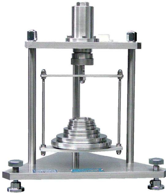
AV-01型空気式重錘型圧力標準器は負圧力を測定する為に開発されたエアーストーンゲージです。測定範囲は、最大で-10 kPa (G)まで測定できます。精度は発生圧力の0.02 %以上を確保し各圧力レンジにおける発生圧力は抜群に安定しており、負圧力における気体圧力計及びデジタル圧力計等各種圧力センサの校正用標準器として最も信頼のおける製品です。尚、本器の使用に際しては、手動加減圧ポンプ(V1型・V2型)等が必要です。
