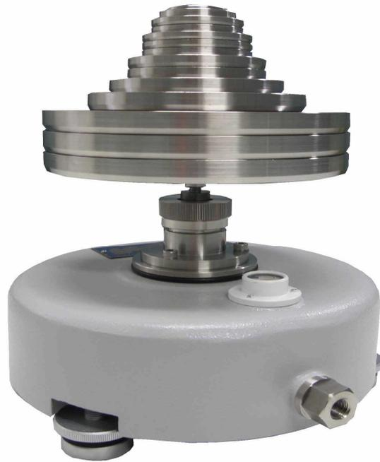
AP-02型空気式重錘型圧力標準器はAP-01型の測定範囲をこえる圧力を測定する為に開発された高圧用エアーストンゲージです。測定範囲は、0.02 MPaより2 MPaで従来の油圧に変わり、高圧を気体で測定できます。精度は発生圧力の0.01 %以上を確保し各圧力レンジにおける発生圧力は抜群に安定しており、高圧における気体圧力計及びデジタル圧力計等各種圧力センサの校正用標準器として最も信頼のおける製品です。尚、本器の使用に際しては、空気ボンベ、高圧コンプレッサー等の圧力源と、圧力コントローラー(V5型)等が必要です。
