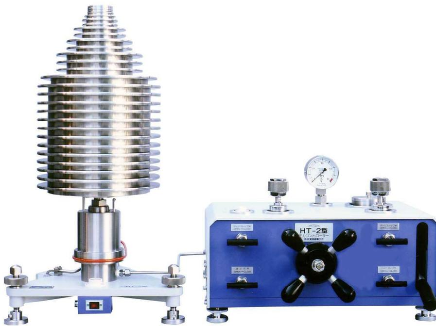
HT-2型高精度重錘型圧力標準器は、最大圧力が10MPa・50MPa・100MPaの3種類があり、油圧により高精度な標準圧力を発生します。主要なピストン・シリンダには超硬合金を使用していることにより耐摩耗性にすぐれ、圧力係数及び温度係数を最小に抑えて設計されています。重錘の回転もモータ駆動により安定した圧力を保持することができます。高精度の圧力標準器として重錘型圧力標準器及び高精度圧力センサ等の校正に最適な製品です。
