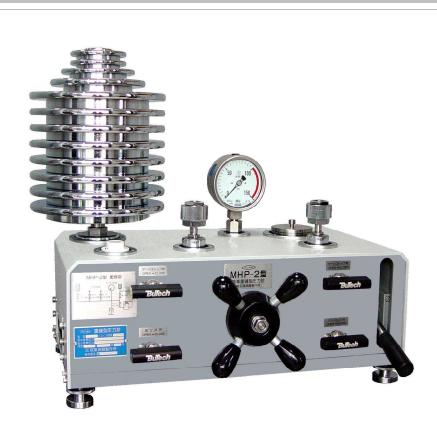
MHP-2型重錘型圧力標準器は中圧における圧力計及び各種圧力センサの校正用圧力標準器です。重錘を用いて油圧により軽い加圧操作で測定でき、予圧ポンプを内蔵していますので容量の多い測定器などの作業が短縮できます。また、加圧及びバルブ操作もスムーズにできる様に前面パネルに設置しました。安全性にも考慮して配管及び継手、主要部品にはステンレス材を使用しています。
